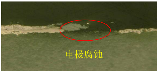
图 1 左端正电极被腐蚀现象图
